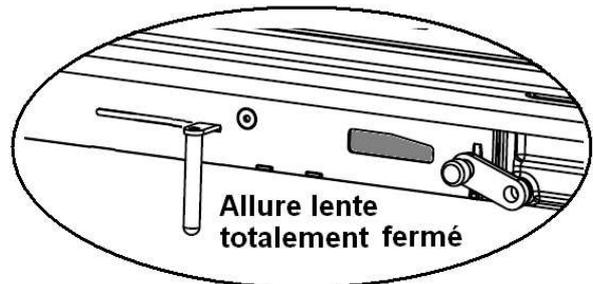
**Quel que soit le mode de fonctionnement désiré (Puissance nominale ou Combustion prolongée), s'assurer que chaque charge de bois s'allume dès son introduction dans l'appareil et que l'inflammation se maintient. Dans le cas contraire, rouvrir quelques instants le « registre de réglage d'allure » en position « allumage » jusqu'à obtenir un embrasement satisfaisant du bois :**
