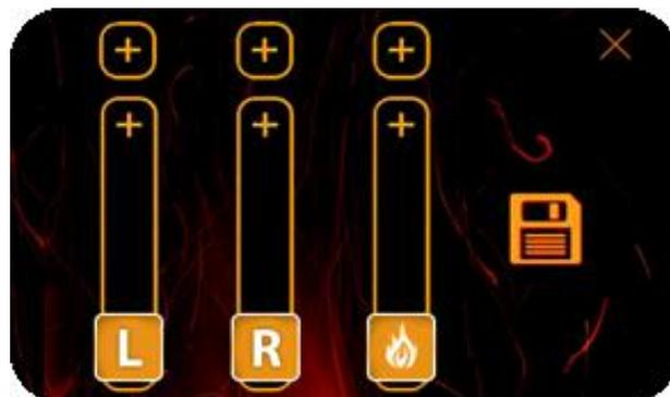
3. Настроить имитацию огня по вашему усмотрению, передвигая ползунки. Первые два ползунка отвечают за скорость и интенсивность поднятия пара. L – левая сторона. R – правая сторона. Третий ползунок отвечает за кол-во пара. Кнопка в виде дискеты – сохраняет установленную настройку в выбранный режим. На этом настройка выбранного режима окончена.
