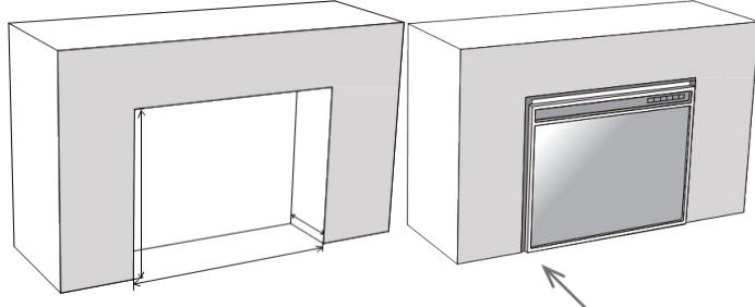
Размеры отверстия: В 508mm x Ш 644mm x Г 160 mm
