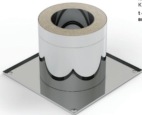
Предназначен для прохода дымохода через стеновые и потолочные перекрытия. Основание ППУ ТЕРМО представляет собой две цилиндрические обечайки, между которыми находится изоляция из базальтовой ваты. К основанию прикреплён экран из нержавеющей стали.
