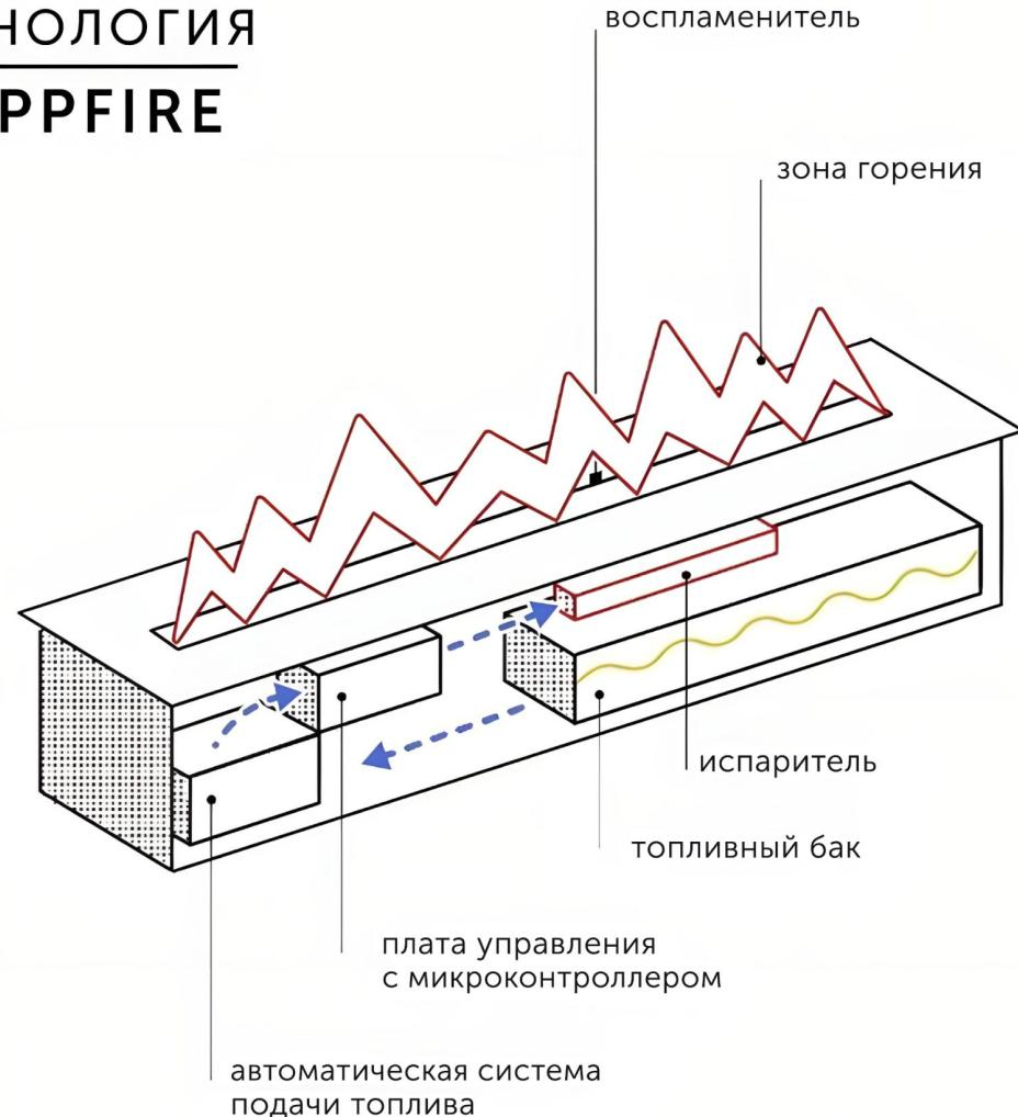
Биокамин оснащен интеллектуальной системой горения паров биотоплива, охлаждения и контроля безопасности, а также быстродействующим процессором промышленного стандарта, который опрашивает систему безопасности более 1000 раз в секунду.
