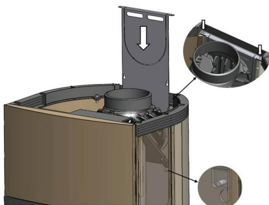
9. Если предполагается подключение печи сзади, установите заднюю соединительную муфту, используя вертикальный упор и два винта. Для удобства вы можете просунуть руку через муфту верхнего подключения.
