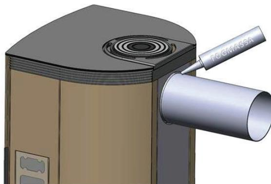
14. Если предполагается установка трубы сверху, теперь надо установить дымовую трубу. Подключите первый модуль, используя герметик. Убедитесь в том, что стык достаточно герметичен.
