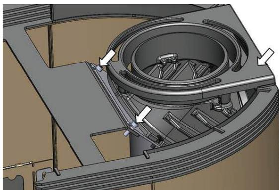
8. Установите плиту отражателя, вставив ее между теплообменником и задней плитой. Убедитесь в том, что две шпоночные канавки посередине плиты надеваются на направляющие винты теплообменника. После этого зафиксируйте плиту отражателя при помощи двух винтов в ламинатном кольце.
