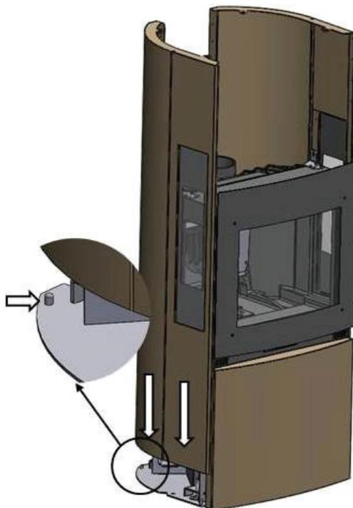
3. Установите заднюю плиту, вдавив загнутый лист металла в прорези в боковых плитах, а затем надавив на плиту вниз. После этого зафиксируйте плиту в этом положении при помощи двух винтов через каждую боковую плиту. Если планируется подключение сзади, предохранительная коробка должна быть снята.
