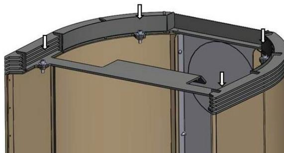
5. Прикрутите винтами кронштейны, заранее установленные на верхнюю плиту печи, к боковым панелям изнутри.
